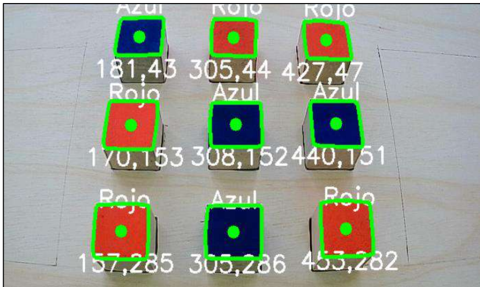
Ilustración 30 – 3: Determinación de los centros e identificador por color de los objetos.
