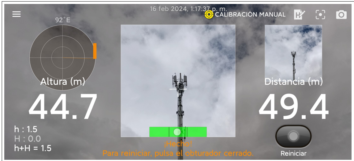
Ilustración 3-2: Medición de altura de la estación base 1 con Smart Measure Realizado por: Sanga C., 2024
