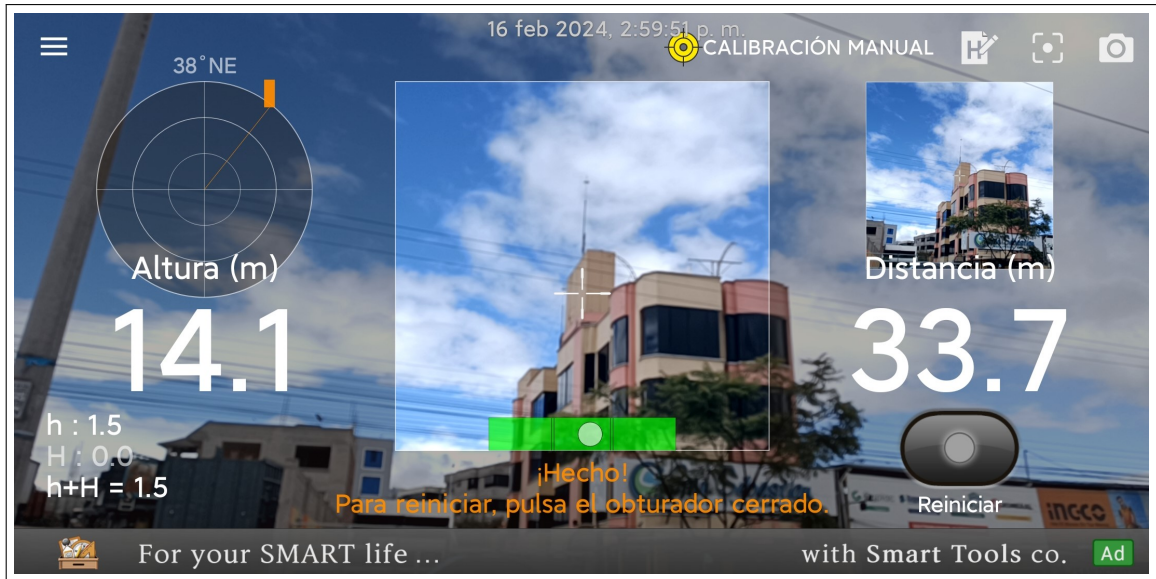
Ilustración 3-4: Medición de altura de la estación base 3 con Smart Measure Realizado por: Sanga C., 2024
