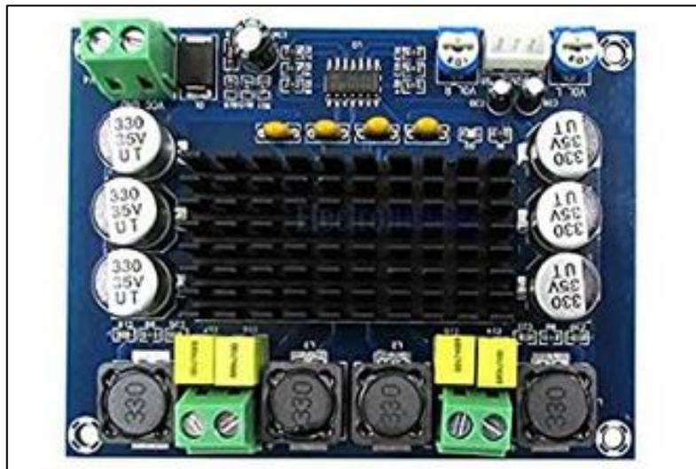
**Ilustración 24-3:** Amplificador de audio TPA3116D2.
