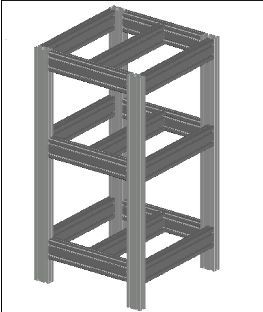
**Ilustración 6-3:** Estructura inferior antivibratoria.
