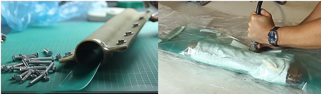
Ilustración 2-29: Aplicación de las capas de fibra de carbono y curado al vacío.
