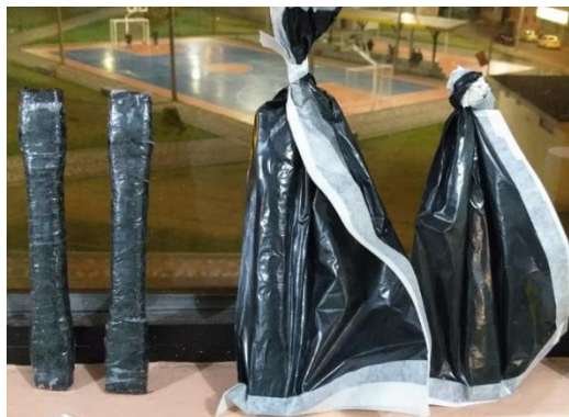
Ilustración 3-97: Probetas al vacío. Fuente: Lirio, A. y Torres, M., 2023.
