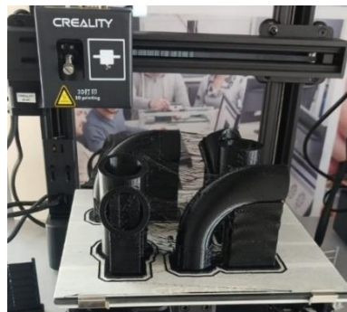
Ilustración 3-79: Impresión con extrusión directa. Fuente: Lirio, A. y Torres, M., 2023.
