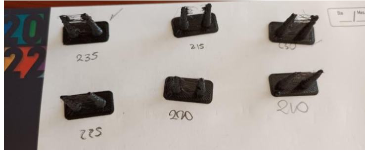
Ilustración 3-78: Pruebas de retracción del filamento. Fuente: Lirio, A. y Torres, M., 2023.
