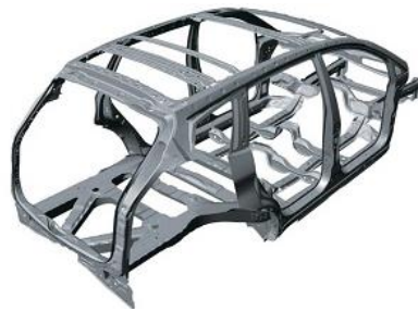
Ilustración 2-4: Bastidor autoportante o monocasco. Fuente: (Rodríguez, 2015, p.2).
