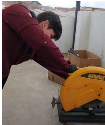
Ilustración 3-87: Corte de los tubos de fibra de carbono. Fuente: Lirio, A. y Torres, M., 2023
