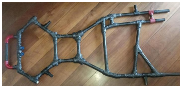
Ilustración 4-6: Chasis forrado de fibra de carbono.
