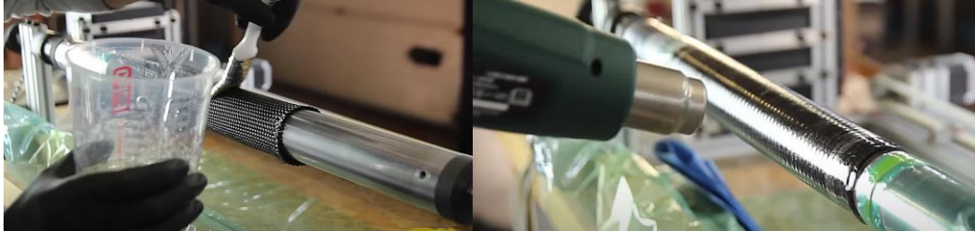
Ilustración 2-26: Aplicación de resina y curado del tubo.
