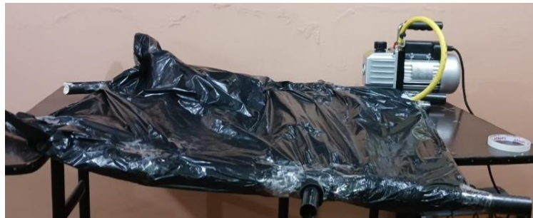
Ilustración 4-5: Generación de vacío en la estructura.
