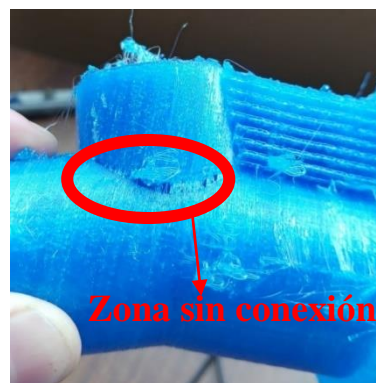
Ilustración 3-82: Falla de impresión por malla inconexa. Fuente: Lirio, A. y Torres, M., 2023.
