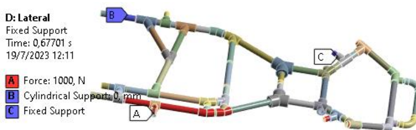
Ilustración 3-36: Condiciones y cargas del análisis lateral.
