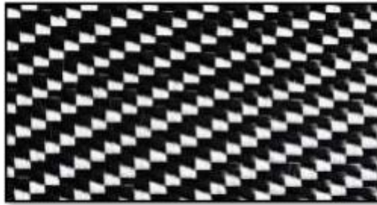
Ilustración 2-15: Tejido sarga. Fuente: (Criollo y Paredes, 2019, p. 21).
