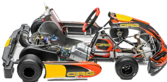
Ilustración 2-10: Kart categoría OK de la marca CRG, modelo Heron. Fuente: (CRG, 2022).
