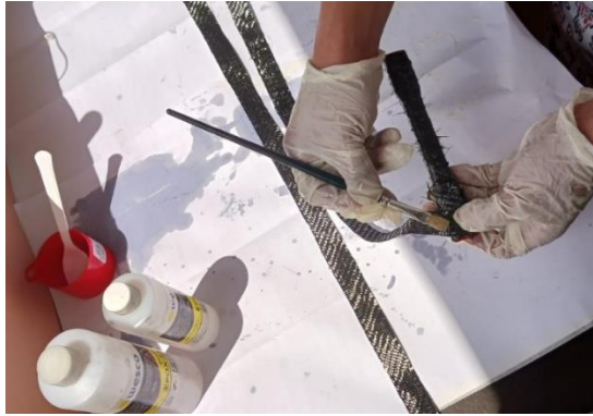
Ilustración 3-96: Forrado de probetas con tela de fibra de carbono. Fuente: Lirio, A. y Torres, M., 2023
