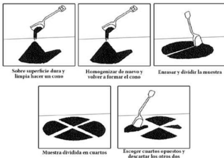
Ilustración 8- 3: Método de cuarteo tipo B.
