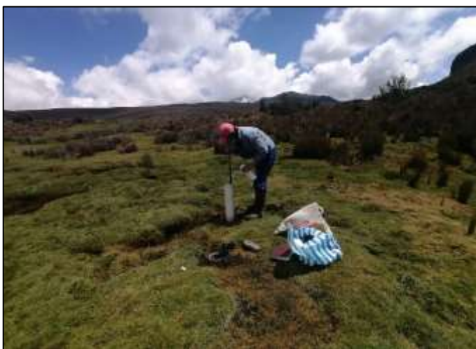
Ilustración 3-3: Toma de muestras de Agua Intersticial
