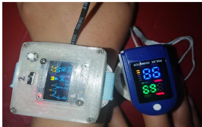
Ilustración 2-4: Toma de muestras entre el pulsímetro automático y el módulo electrónico.
