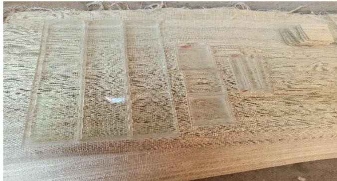
**Ilustración 3-13:** Moldes y fibra para realizar las probetas
