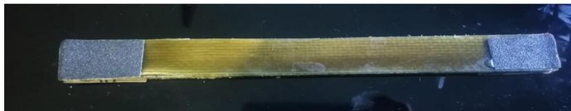
**Ilustración 3-18:** Probetas con trozos de lija para ensayos de tracción.
