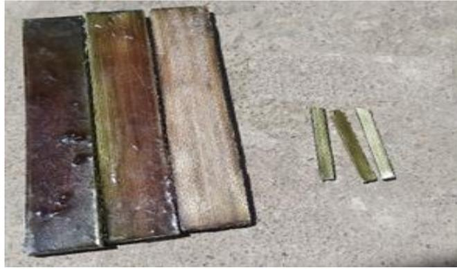
**Ilustración 3-17:** Desmolde de probetas para ensayos.
