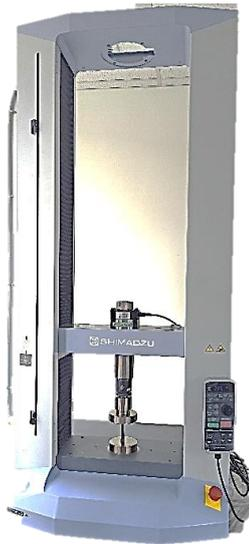
**Ilustración 2-21:** Máquina de ensayo SHIMADZU AGS - 50
