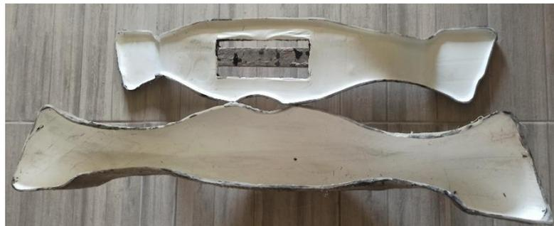
**Ilustración 3-20:** Elaboración del molde en dos piezas del frontal.
