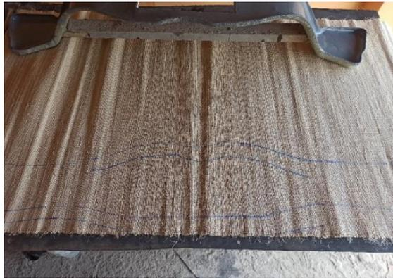
**Ilustración 3-21:** Fibra seccionada para el molde.
