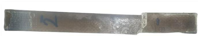
**Ilustración 4-4:** ETP 01-2 después del ensayo de tracción
