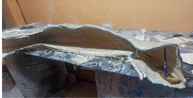
**Ilustración 3-25:** Inicio del ciclo de curado del molde
