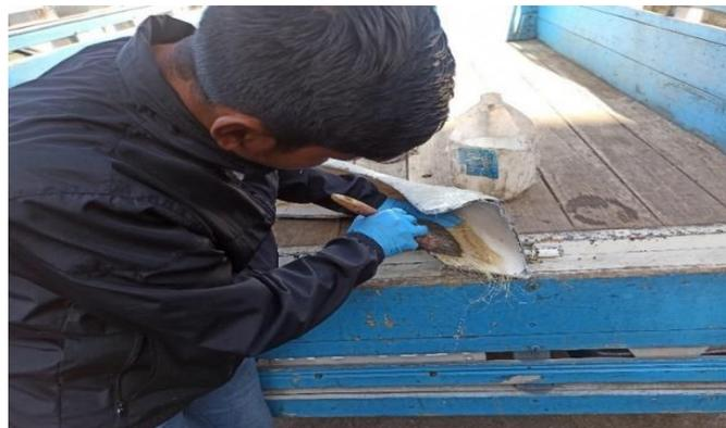
**Ilustración 3-24:** Aplicación de la resina y fibra al molde.
