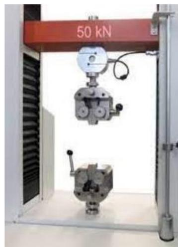
**Ilustración 2-19:** Máquina de ensayos Metrotec 50 KN.
