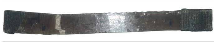
**Ilustración 4-3:** ETP 01-1 después del ensayo de tracción
