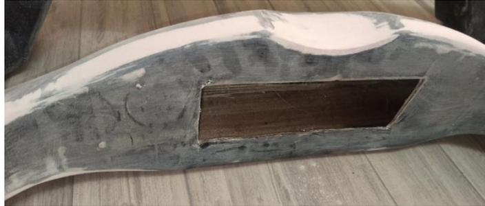
**Ilustración 3-27:** Unión de las dos partes de la figura final
