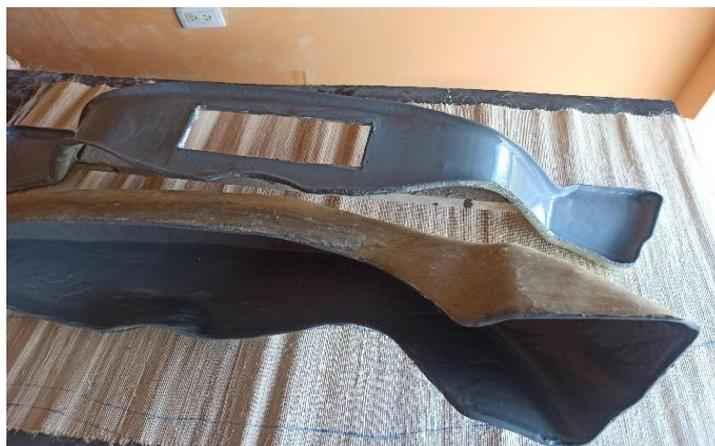
**Ilustración 3-22:** Molde con la inclusión de cera desmoldante.
