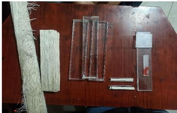
**Ilustración 3-11:** Moldes para los ensayos en acrílico
