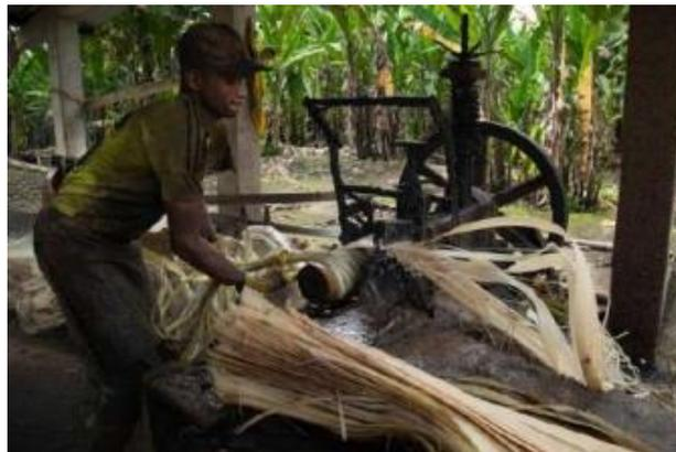
**Ilustración 3-5:** Maquina desfibradora del material.
