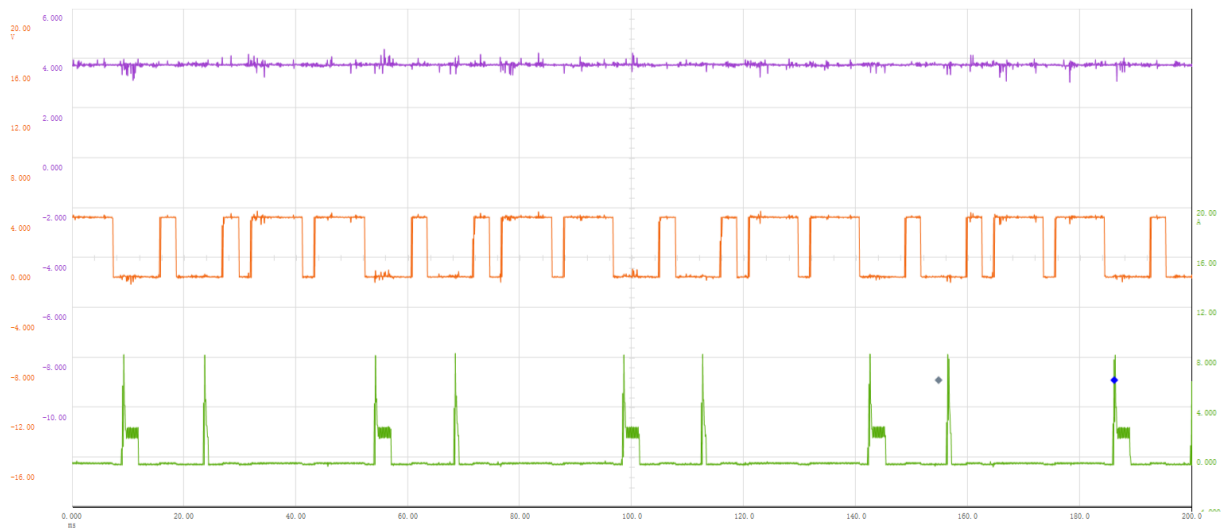
Ilustración 4-11: Oscilograma del sensor de la chapaleta, sensor CMP y la señal del inyector; cuando se encuentra a un \pm 60 el porcentaje del pedal del acelerador.
