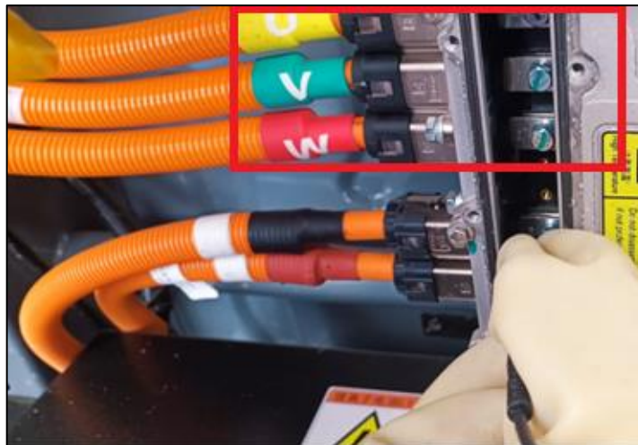
Ilustración 3-17: Identificación de fases (Inversor - Motor)
