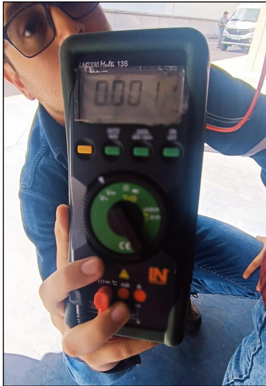
Ilustración 3-15: Verificación de voltaje
