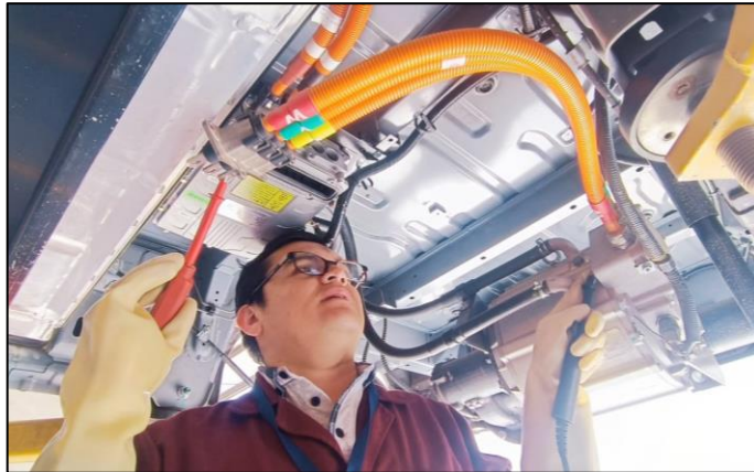
Ilustración 3-20: Conexión Fase - Tierra (Medición)
