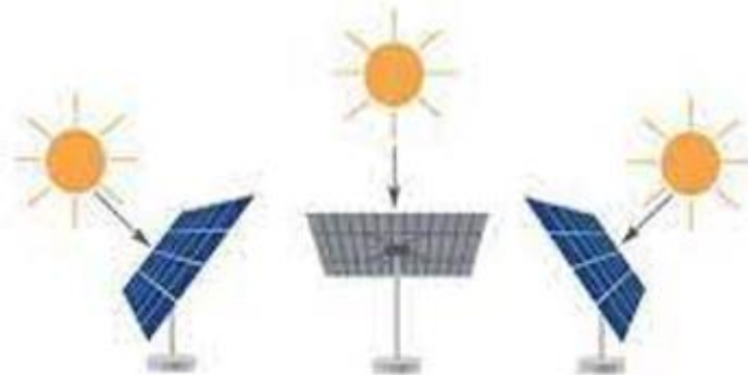
Figura 17-3: Movimientos de la celda fotovoltaica dependiendo de su radiación. Realizado por: Totoy E;2022
