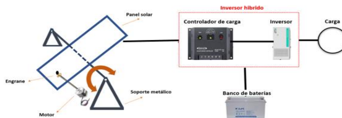
Figura 29-3: Diagrama del sistema fotovoltaico aislado (SFA). Realizado por: Totoy E;2022
