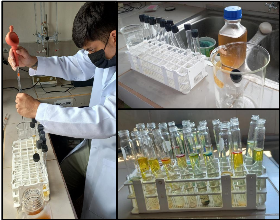
Siembra e identificación de coliformes fecales método tubos INDOL
