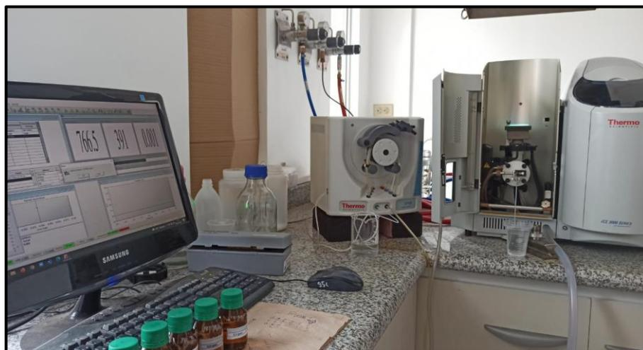
**Ilustración 10-1:** Equipo de Espectrometría de Absorción Atómica ESPOCH
