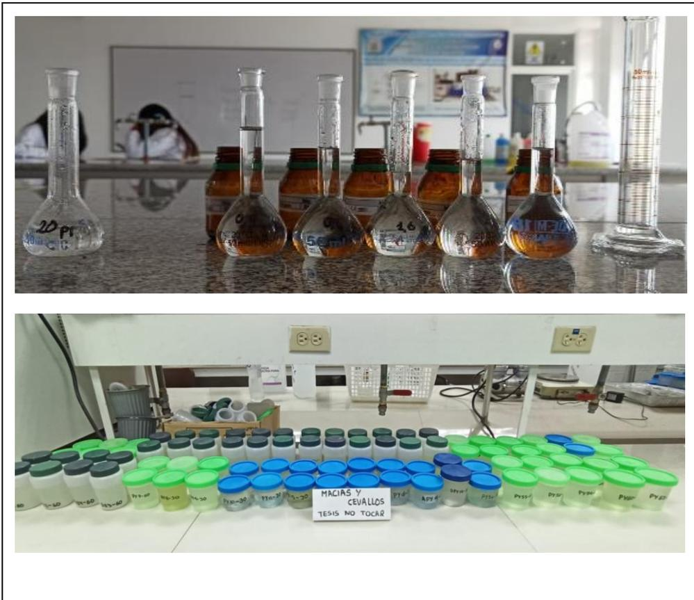
**ANEXO F: DETERMINACIÓN DE ALUMINIO USANDO PALINTEST WATER ANALYSIS TECHNOLOGIES**
