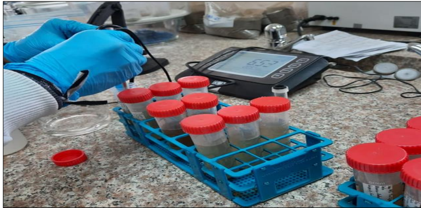
Ilustración 5-3: Determinación de pH de muestras de suelo y biomasa con el uso de pH-metro
