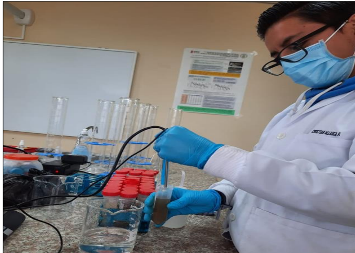
Ilustración 6-3: Determinación de CE de muestras de suelo y biomasa con el uso de pH-metro
