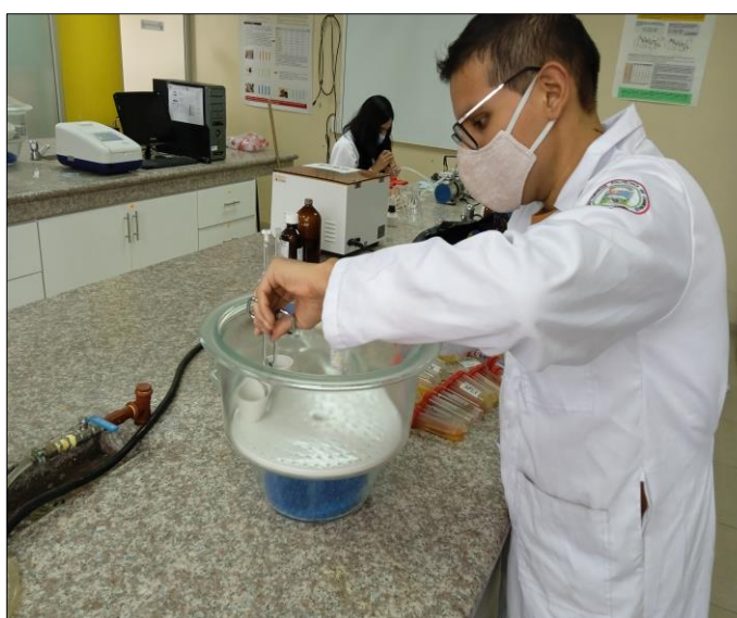
Ilustración 7-3: Determinación de materia orgánica
