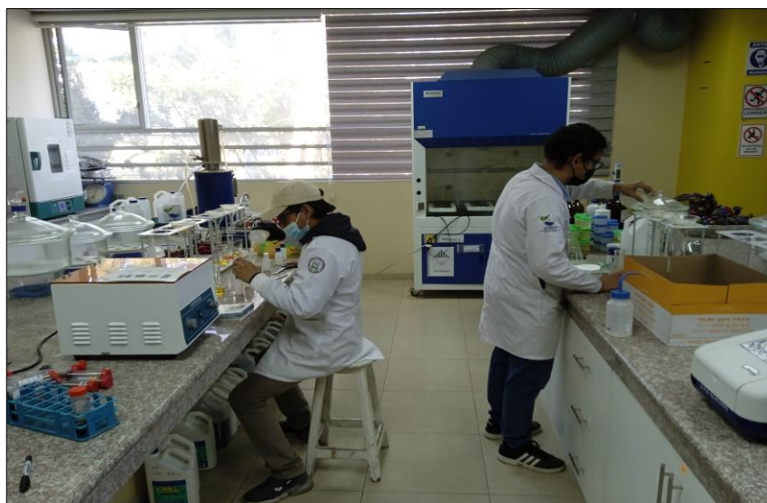
Ilustración 11-3: Digestión ácida de muestras de suelo y biomasa
