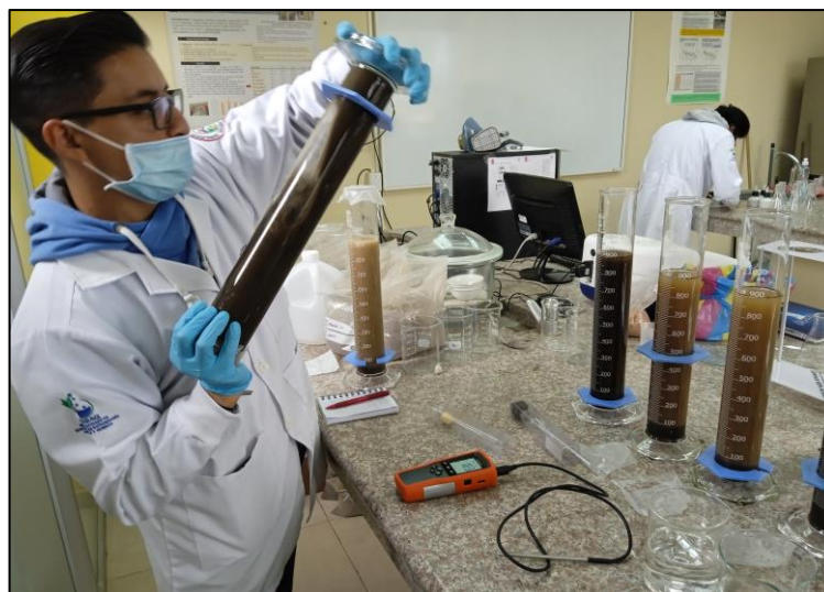
Ilustración 9-3: Determinación de textura de muestras de suelo
