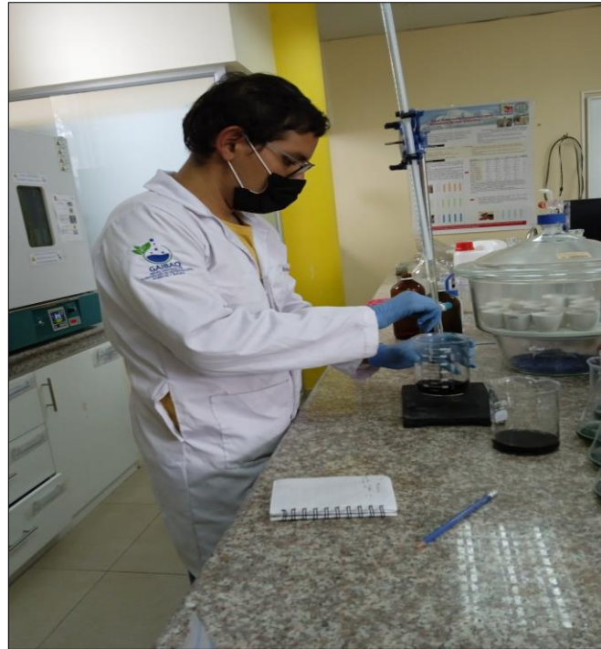
Ilustración 10-3: Determinación de carbono orgánico oxidable en muestras de suelo
