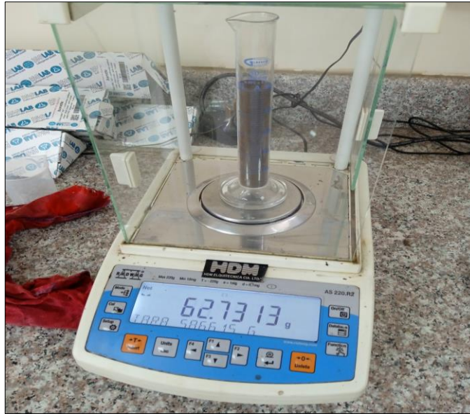
Ilustración 8-3: Determinación de densidad aparente de muestras de suelo
