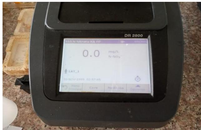
**Ilustración 3-5:** Espectrofotómetro, medición de nitratos
