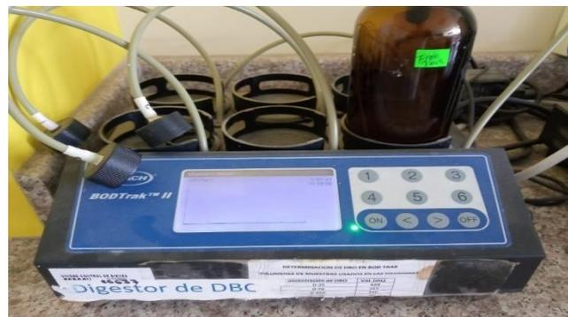
**Ilustración 3-7:** Digestor de DBO
