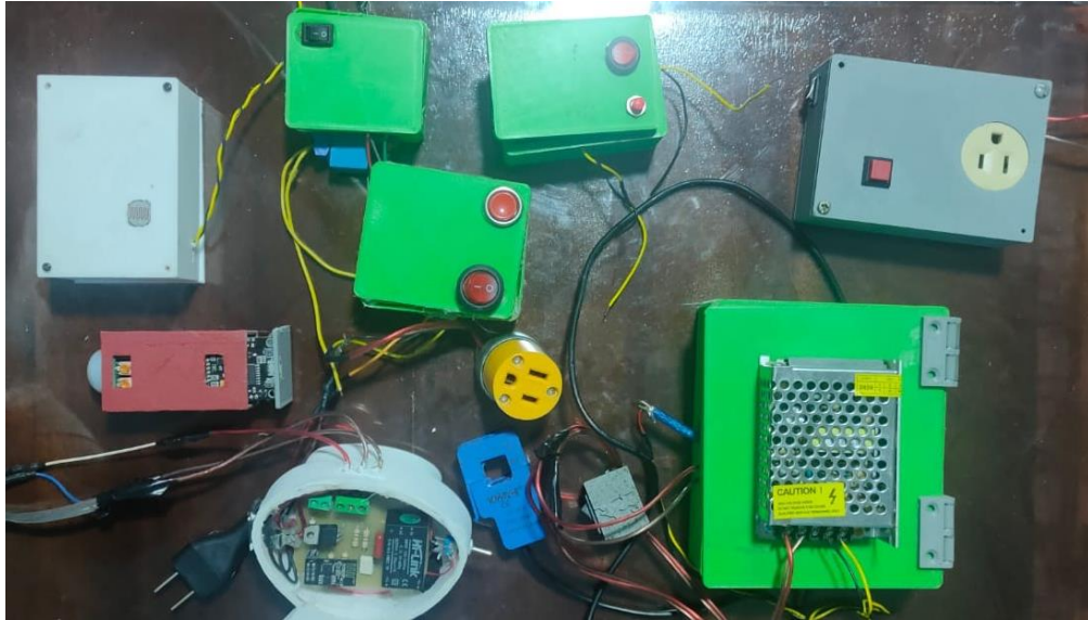
Figura23-2: Prototipo domótico completo previo a la instalación.
