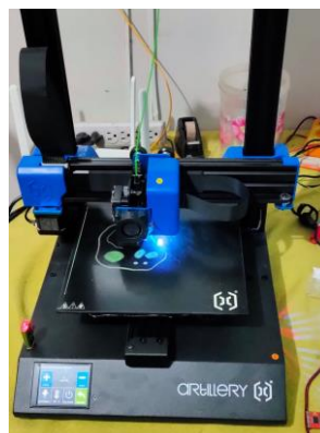
Figura17-2: Impresión de carcasas con Artillery Genius y PLA.
