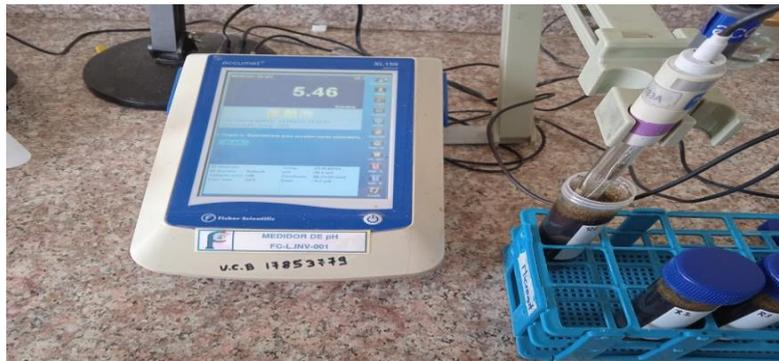
**Ilustración 15-2:** Determinación de pH
