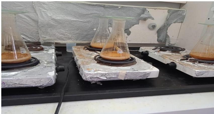
**Ilustración 29-3:** Digestión de muestras para análisis de metales pesados
