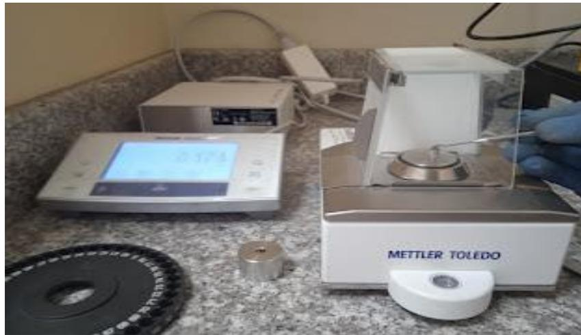
**Ilustración 28-2:** Pesaje de muestras para la determinación de Nitrógeno
