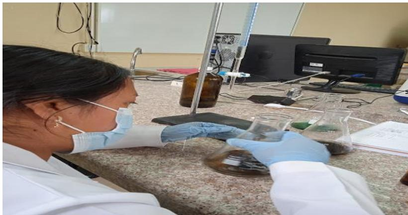
**Ilustración 17-2:** Determinación de carbono oxidable
