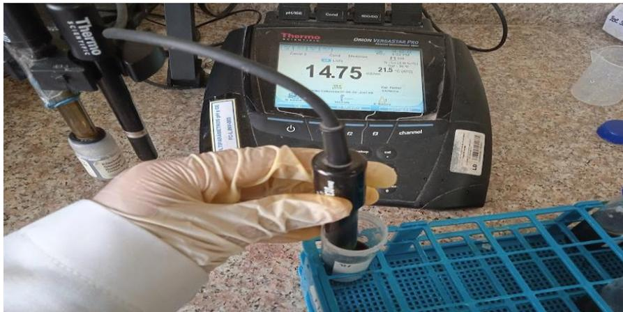
**Ilustración 16-2:** Determinación de conductividad eléctrica
