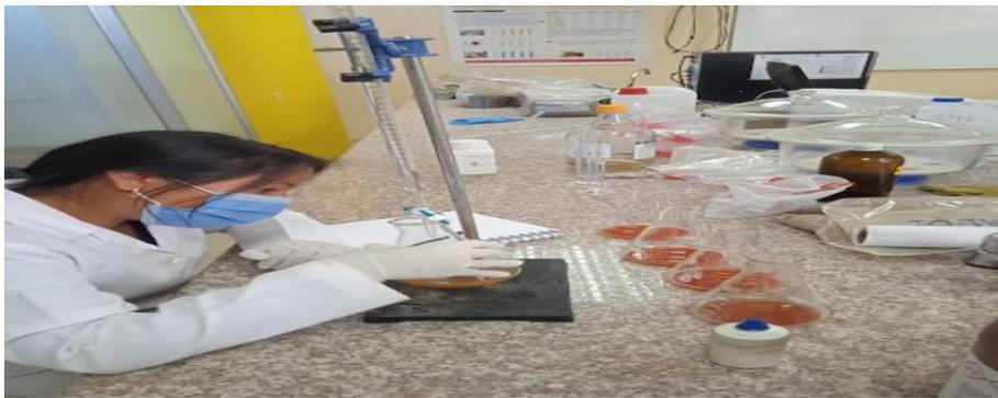
**Ilustración 26-2:** Análisis de Cloruros por titulación
