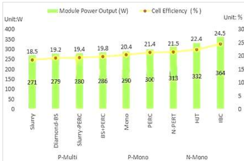
Figura 4-1: Eficiencia de la célula y salida de potencia del módulo solar por diferentes tipos.
