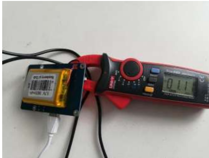
Figura 25-2. Medición de corriente estado activo
