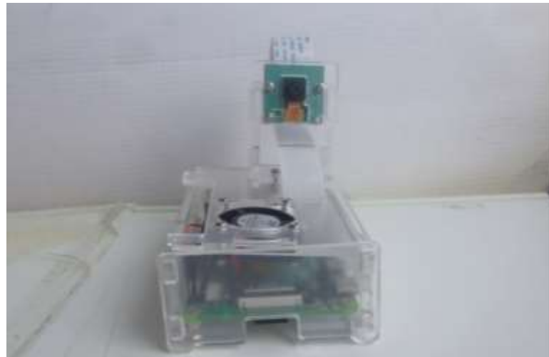
Figura 12-2: Cámara RPi-CAM-V2 acoplada al Case. Realizado por: Guanga, A. & Paucar, L. 2021
