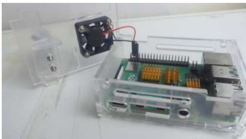
Figura 11-2: Componentes de regulación de temperatura. Realizado por: Guanga, A. & Paucar, L. 2021
