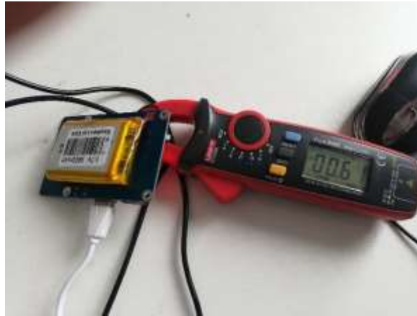
Figura 24-2. medición de corriente estado pasivo Realizado por: Guanga, A. & Paucar, L. 2021
