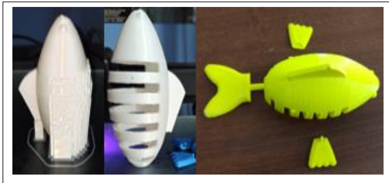
Figura 13-2: Impresión en 3D del robot pez bioinspirado.
