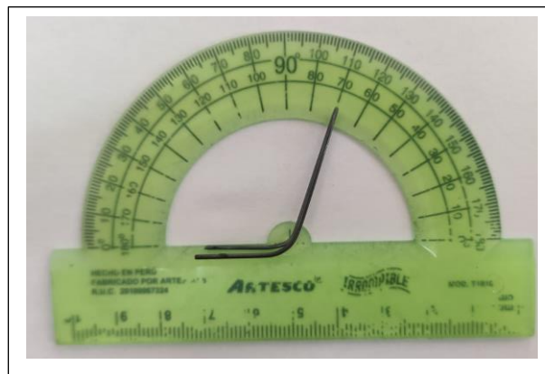
Figura 3-3: Grado final del actuador después de pruebas realizadas.
