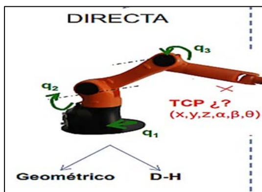
Figura 14-1. Cinemática de posición directa
