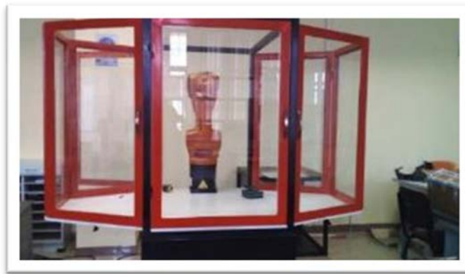
Figura 59-2. Estructura de seguridad. Realizado por: Amangandi M.; Mendoza N. 2020.
