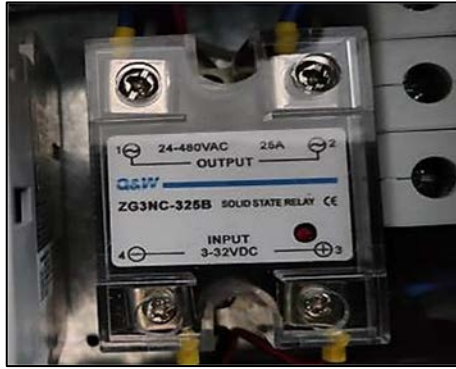
Figura 45-2. Relé de estado solido Fuente: (Amangandi y Mendoza, 2020)
