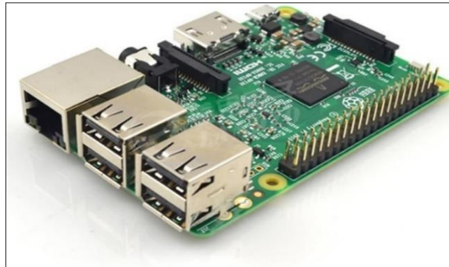
Figura 8-1. Computador de placa reducida Raspberry Pi 3B
