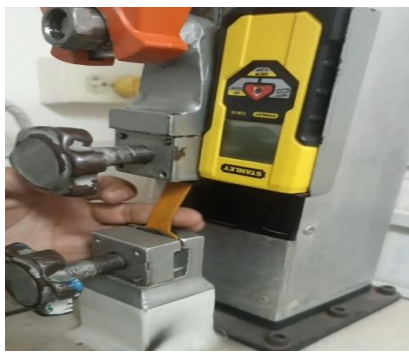
Ilustración 3-4: Máquina para el análisis de resistencia a la tensión y elongación.
