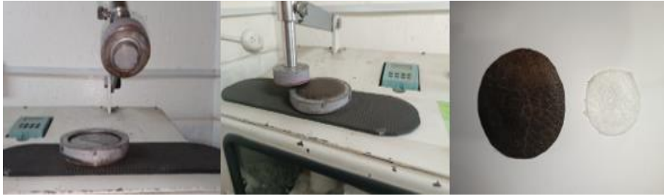
Ilustración 3-5: Equipo para medir la resistencia al frote y probetas para el análisis
