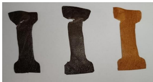
Ilustración 3-3: Probetas del cuero ovino, utilizadas para los ensayos de resistencia a la tensión y elongación.
