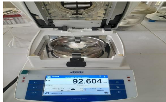
Determinación de la Materia seca para reportar los porcentajes de humedad.
