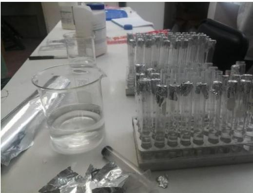
**Figura 9:** Preparación de materiales para colocar en el autoclave
