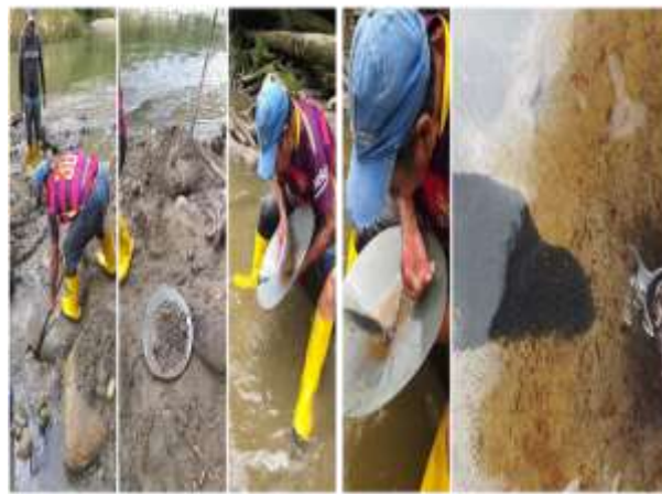
Figura 4-1: Técnica de bateo en minería artesanal
