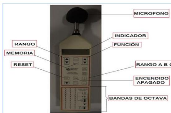
**Figura 2-1:** Componentes del sonómetro
