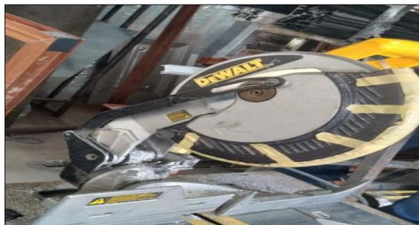
**Figura 10-1:** Cortadora de metal
