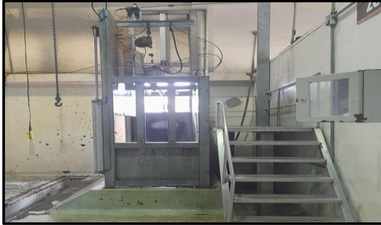
**Ilustración 3-4:** Cajón de aturdimiento y baño de aspersión.
