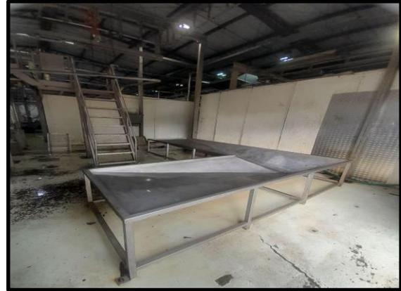
**Ilustración 4-4:** Zona de suspensión de reses en el birrail, corte de cabeza y patas anteriores (izq.); y pila de desangrado (der.)
