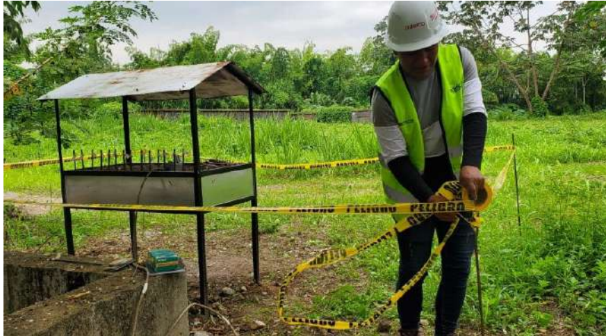
Ilustración 3-30: Ubicación de las probetas para evitar el contacto entre sí Realizado por: (Guallo, H; Guamán, J, 2023)
