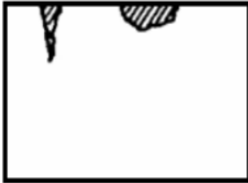
Ilustración 2-3: Corrosión por picadura
