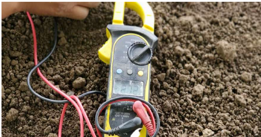
Ilustración 3-32: Medición de voltaje de las probetas por protección catódica Realizado por: (Guallo, H; Guamán, J, 2023)
