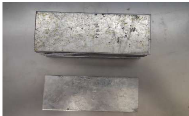
Ilustración 3-20: Acero ASTM A36 galvanizado G-40
