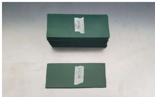
Ilustración 3-27: Probetas acero ASTM A36 recubiertas
