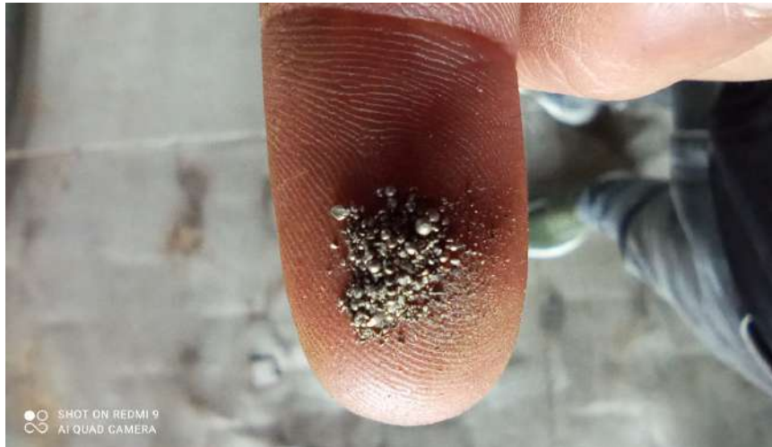
Ilustración 3-23: Grano redondo de metal abrasivo
