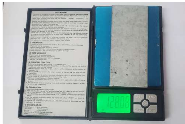
Ilustración 3-17: Balanza de precisión de 500gramos
