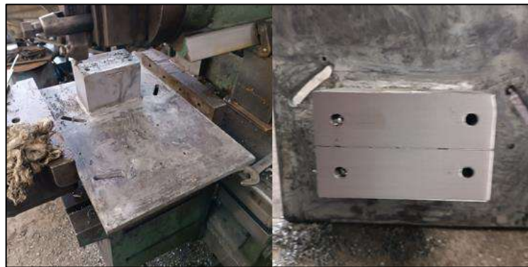
Ilustración 3-51: Rectificado de las bases de las chumaceras de la segunda parte
