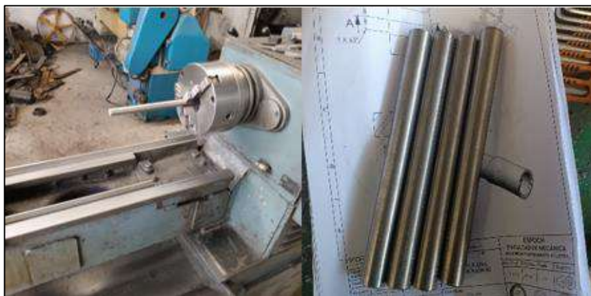
Ilustración 3-56: Mecanizado de los ejes conducidos
