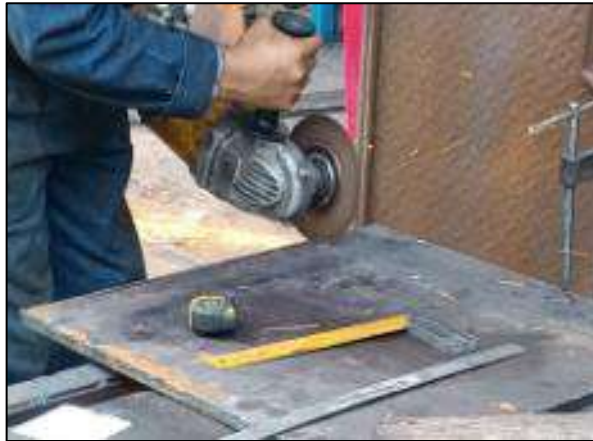
Ilustración 3-53: Corte de los soportes del alternado
