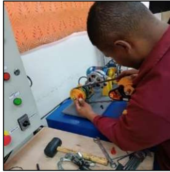
Ilustración 3-73: Alineación de poleas
