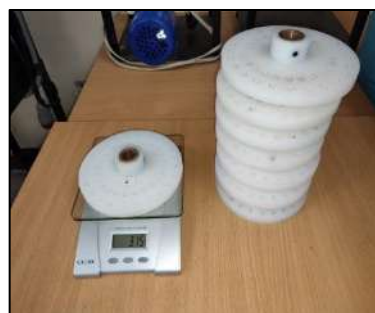
Ilustración 3-61: Pesado de los disco de desbalanceo
