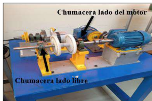
Ilustración 3-2: Prueba de análisis vibracional
