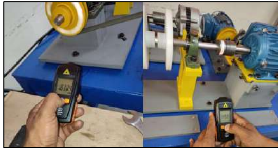
Ilustración 3-77: Medición de velocidad de rotación
