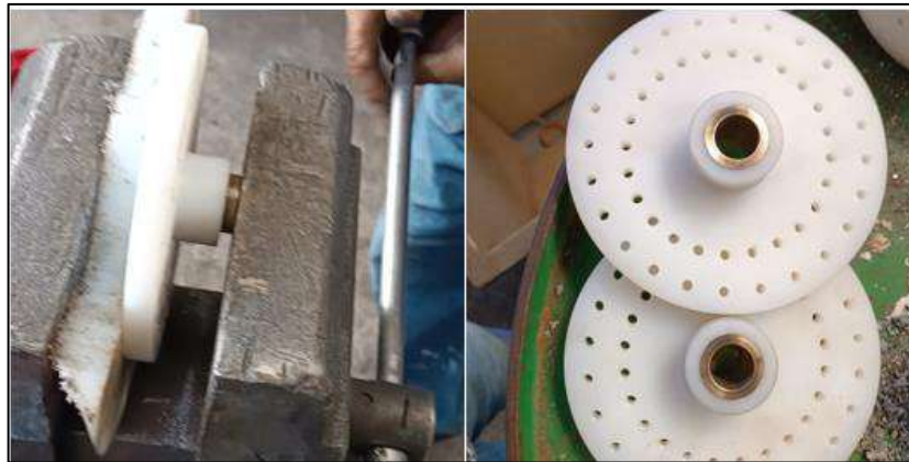
Ilustración 3-60: Montaje del bocín en los discos de desbalanceo
