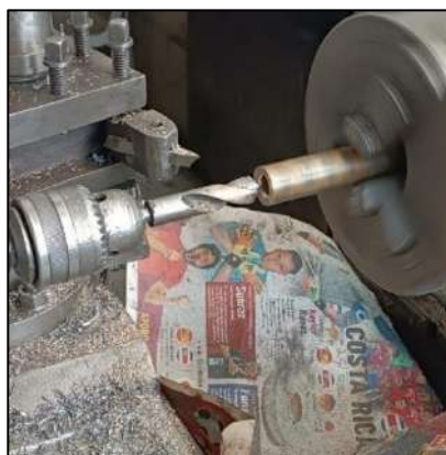
Ilustración 3-50: Mecanizado de los bocines
