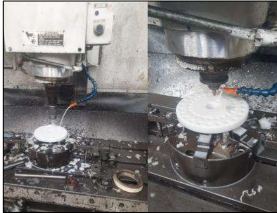
Ilustración 3-49: Perforado de los discos de desbalanceo
