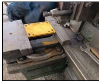
Ilustración 3-45: Rectificado de las placas móviles
