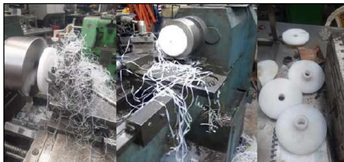
Ilustración 3-48: Mecanizado de los discos de desbalanceo
