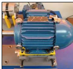
Ilustración 3-12: Motor trifásico de 1Hp instalados
