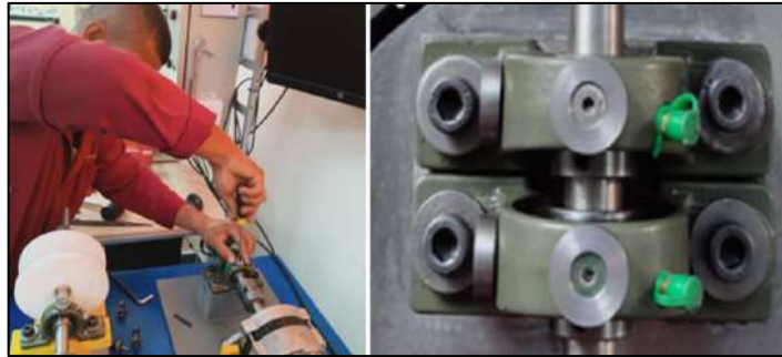
Ilustración 3-70: Montaje de los insertos
