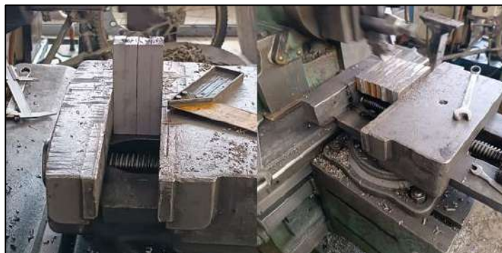
Ilustración 3-54: Rectificado de los soporte del alternador
