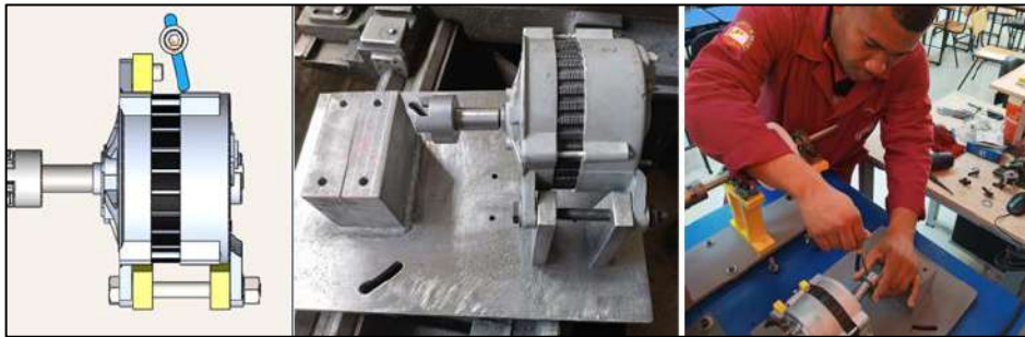
Ilustración 3-68: Montaje de los acoples del alternador
