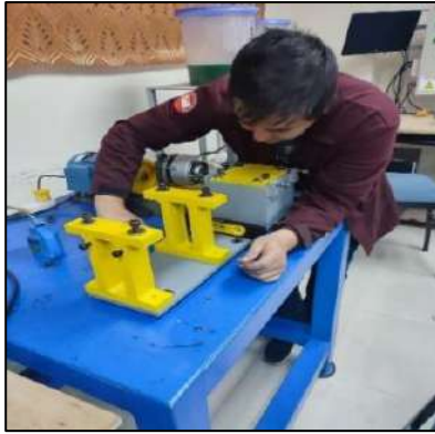
Ilustración 3-71: Nivelación de la base principal
