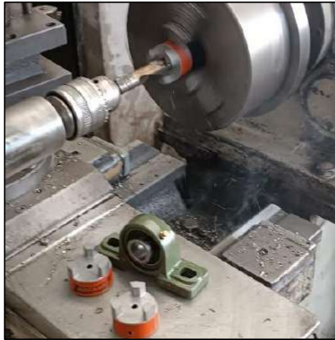
Ilustración 3-59: Perforado de los acoples flexibles
