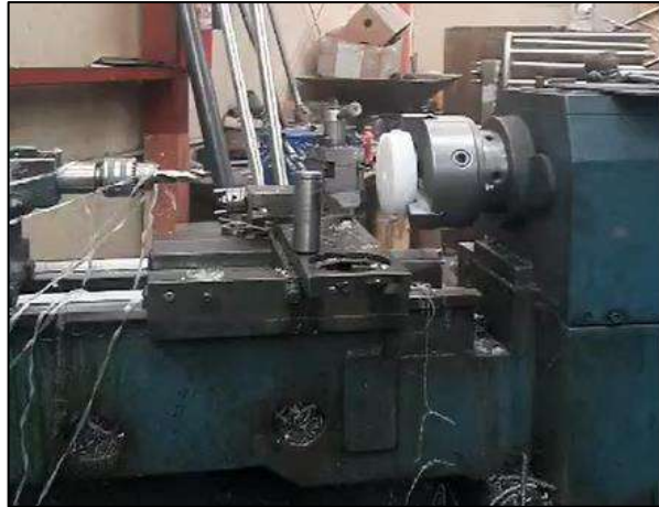
Ilustración 3-47: Rectificado de la superficie de los discos de nylon
