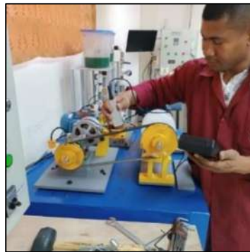
Ilustración 3-74: Verificación del tensado de la banda
