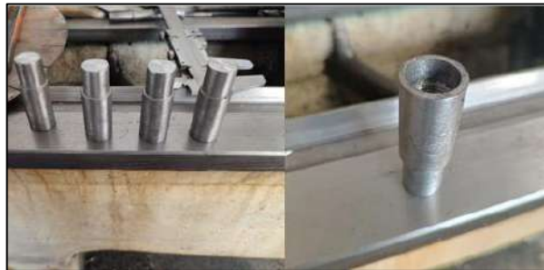
Ilustración 3-57: Mecanizado de los acoples del alternador
