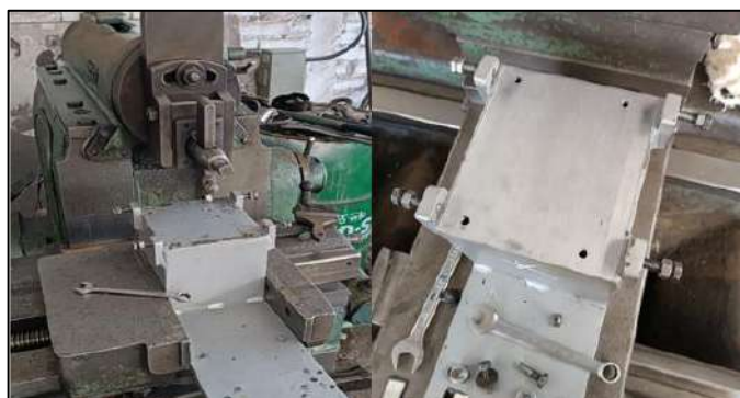
Ilustración 3-44: Rectificado de las bases de los motores
