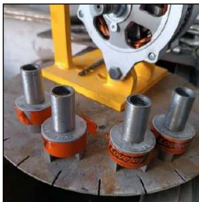
Ilustración 3-67: Montaje del acople flexible
