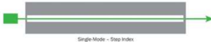
Ilustración 2-3 : Trayectoria en una fibra monomodo.
