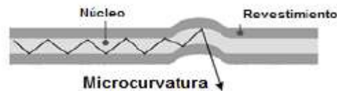
Ilustración 2-8: Pérdidas por Microcurvaturas.
