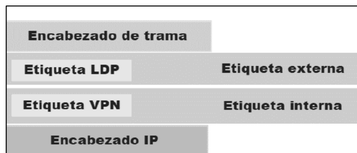
Ilustración 2-3: Representación del Stack de etiquetas para una VPN MPLS
