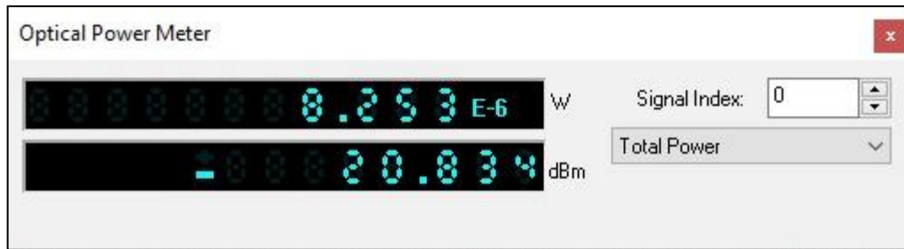
Ilustración 10-4. Potencia recibida en la ONT del usuario más lejano
