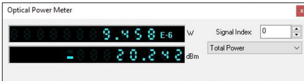
Ilustración 9-4. Potencia recibida en la ONT del usuario más cercano
