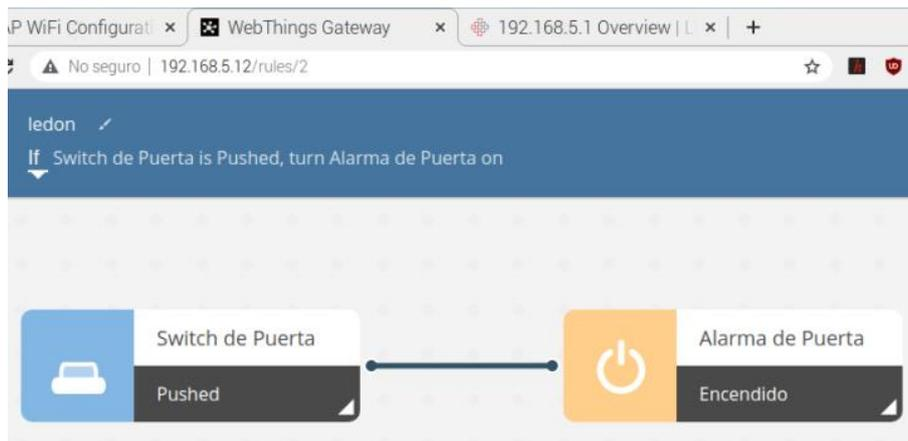
**Figura 38-3:** Regla definida para el control de una alarma y un pulsador.
