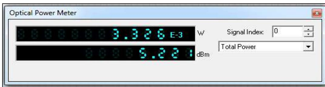
**Figura 7-3:** Potencia a la salida de la OLT
