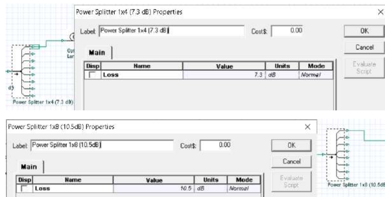
Figura 7-3. Configuración de la atenuación de Splitters en la simulación
