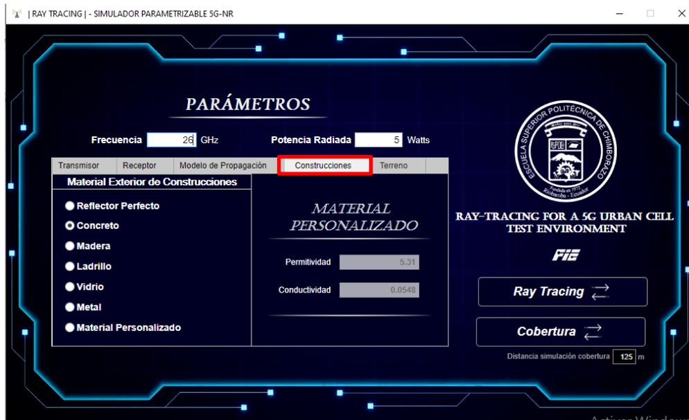
**Figura 12-2:** Configuración parámetros de materiales de construcción
