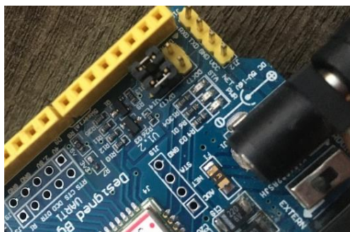
Figura 22-3: Colocación de Jumpers en los pines 7 y 8.
