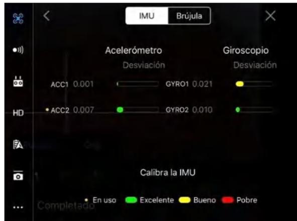
**Figura 5-3:** Estado IMU y brújula rover aéreo
