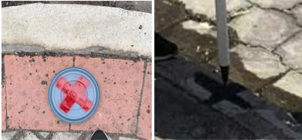
**Figura 4-3:** Puntos de control foto identificables
