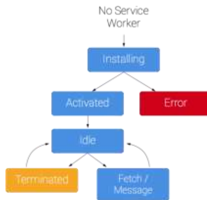
Figura 1-2: Ciclo de vida del service worker de una aplicación web progresiva
