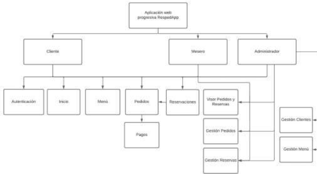
Figura 7-3: Diagrama jerárquico de módulos de la aplicación Respedapp
