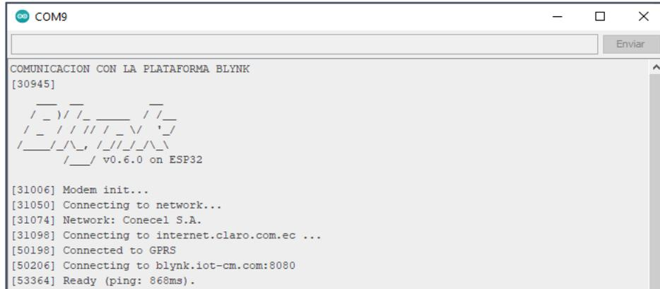
**Figura 9-3:** Monitor Serial de la comunicación con el servidor Blynk
