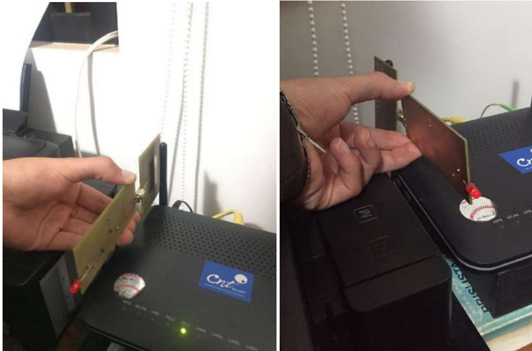
Figura 30-3: Cosechamiento de energía router WiFi con un LED como carga
