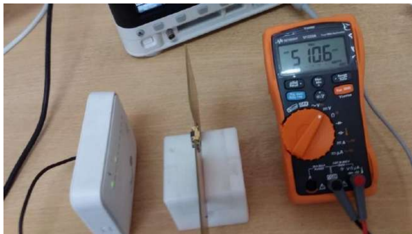
Figura 29-3: Voltaje a la salida del dispositivo usando modem WiFi como fuente
