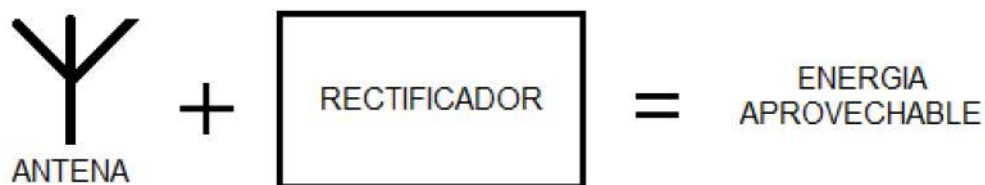
Figura 24-1: Sistema de cosecha de energía de RF
