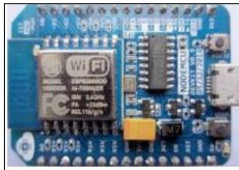
**Figura 13-1:** NodeMCU ESP8266 v9.
