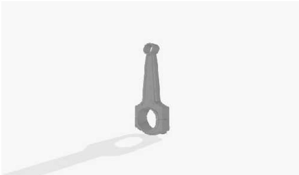
**Figura 25-4.** Biela, modelado 3D.
