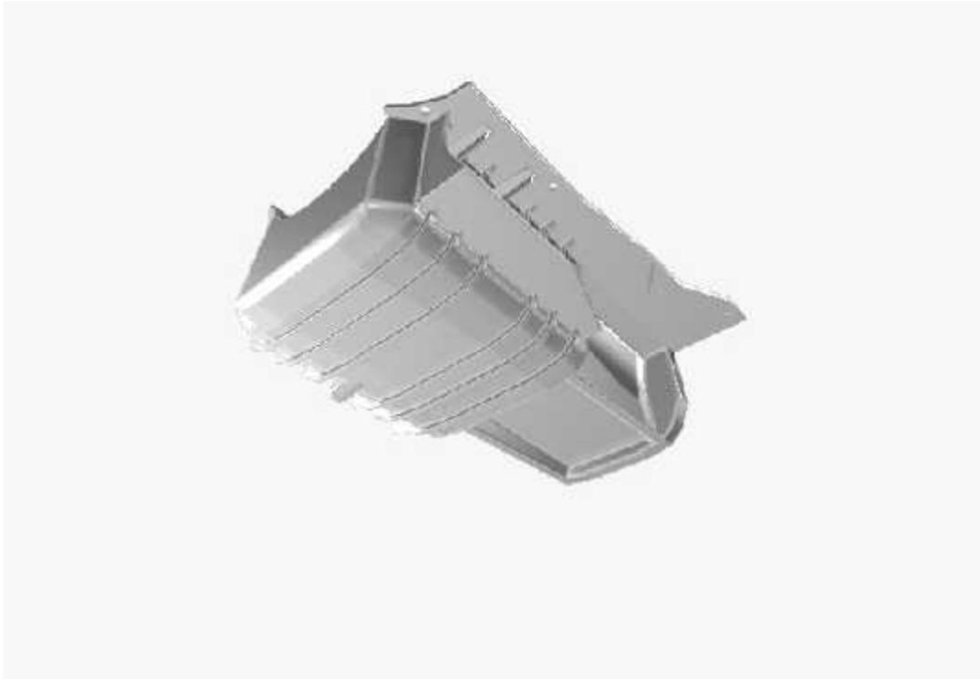
**Figura 26-4.** Cárter, modelado 3D.
