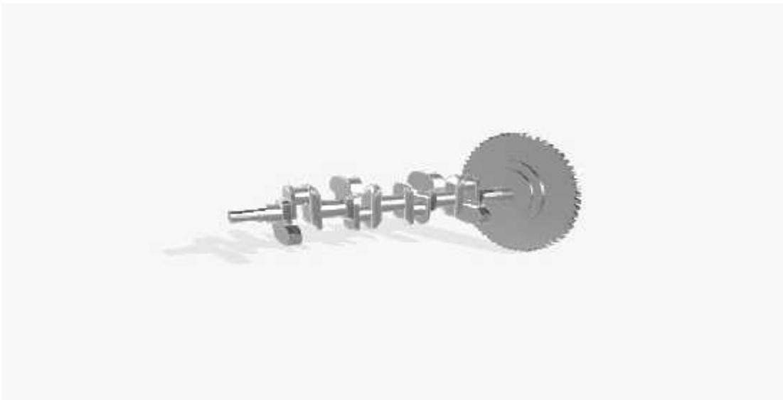
**Figura 17-4.** Volante, modelado 3D.
