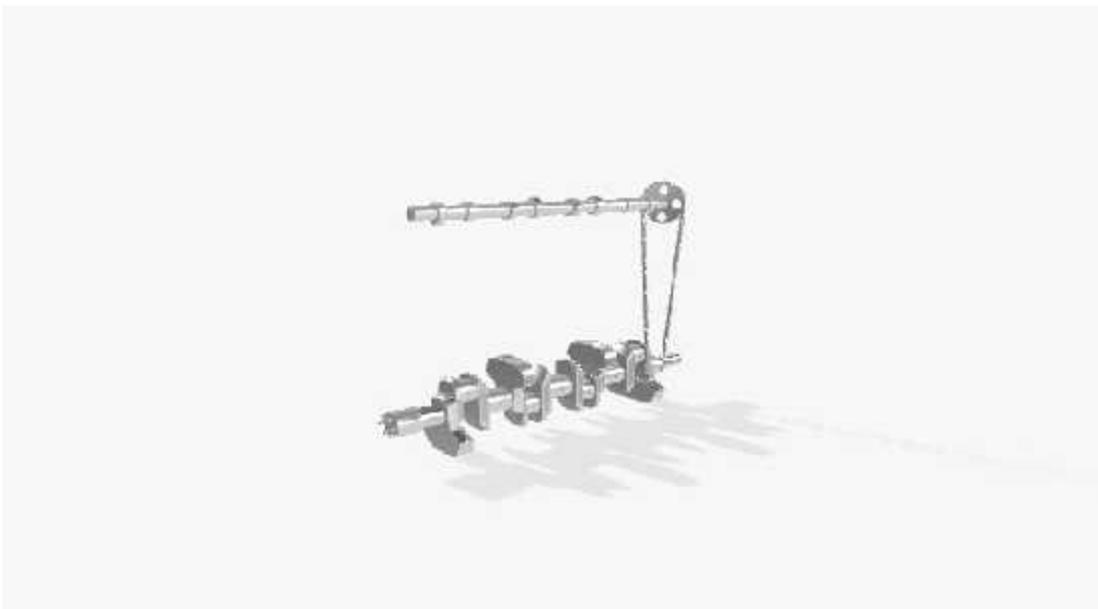
**Figura 27-4.** Cadena de distribución, modelado 3D.
