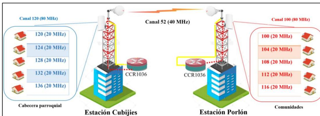
**Figura 4-3:** Distribución de canales para evitar interferencias co-canal
