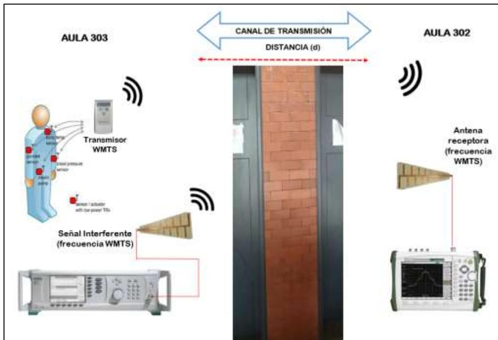
**Figura 48-2.** Evaluación del dispositivo transmisor NLOS mediante el analizador de espectro.
