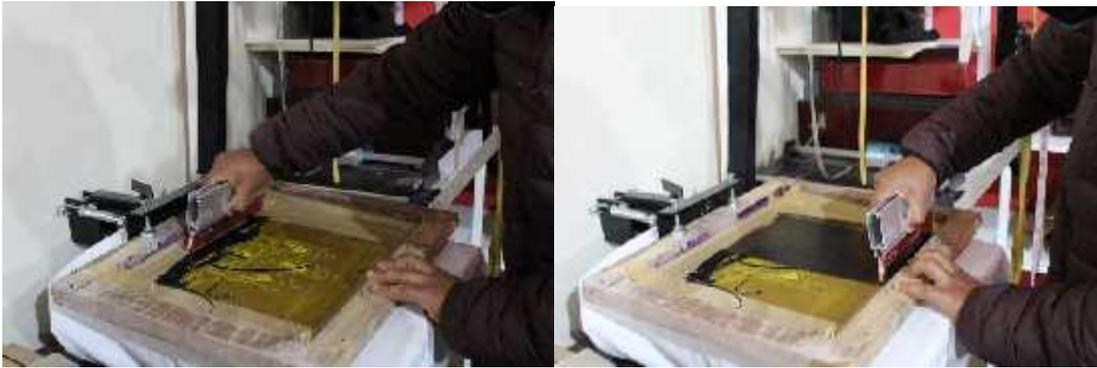
**Figura 20-3** Distribución homogénea de la pintura
