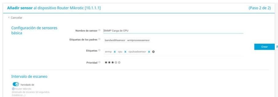
**Figura 84-3.** Configuración de sensor SNMP para la CPU.
