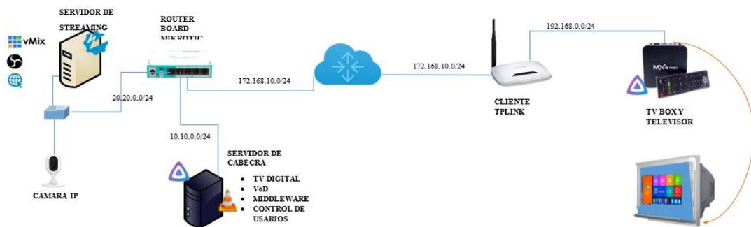
**Figura 16-3.** Esquema de prototipo de cabecera IPTV.
