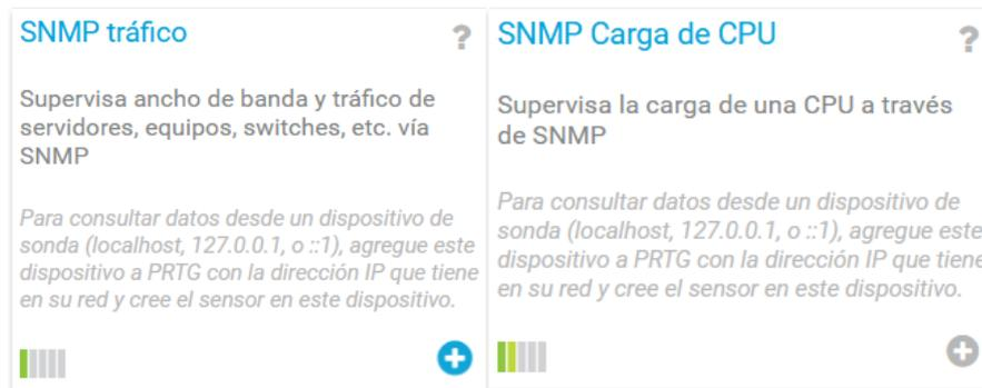
**Figura 77-3.** Sensores de tráfico y de CPU con SNMP.
