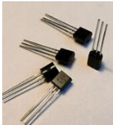
Figura 15-2. Transistor 2N3904 Realizado por: (Cruz y Jaramillo, 2021)
