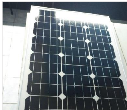
Figura 2-2. Panel solar EGE-50P-36 Realizado por: (Cruz, y otros, 2021)
