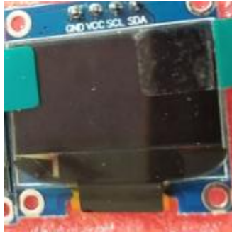
Figura 19-2. OLED 128X64 Realizado por: (Cruz y Jaramillo, 2021)
