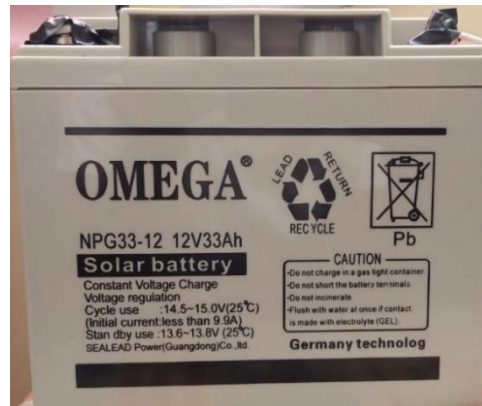
Figura 3-2. Batería OMEGA NPG33-12 Realizado por: (Cruz y Jaramillo, 2021)
