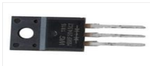
Figura 16-2. Diodo Schottky MBR2045CT Realizado por: (Cruz y Jaramillo, 2021)
