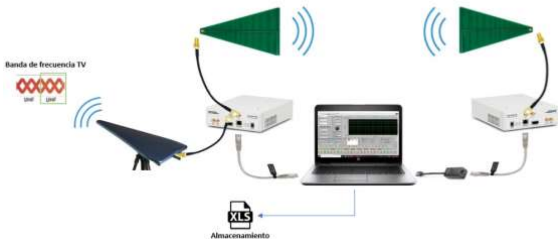
Figura 4-3. Diseño del sistema de radio cognitiva.
