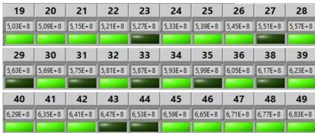
Figura 10-4. Canales libres y ocupados determinados por el sistema radio cognitiva.
