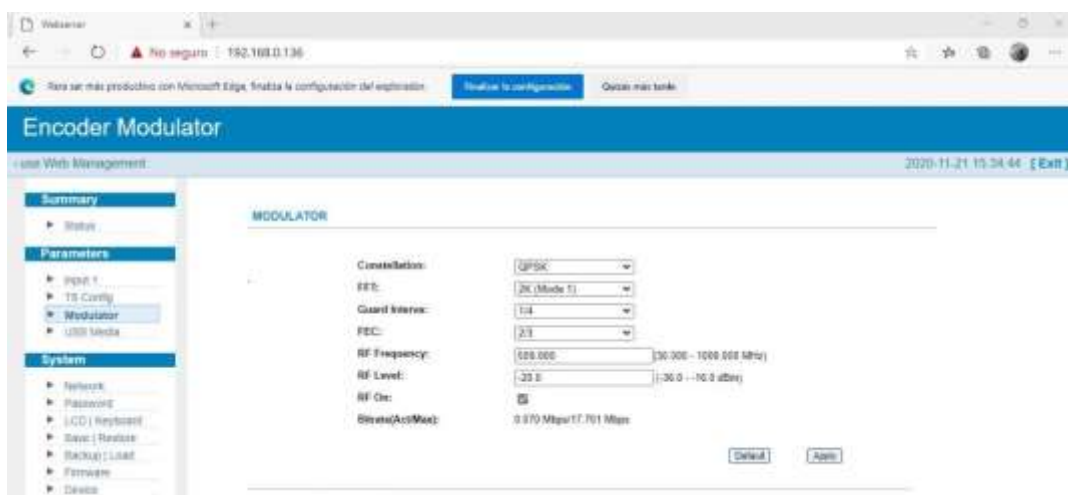
Figura 22-4. Configuración de la transmisión del usuario primario.
