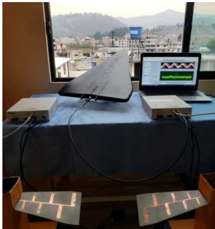
Figura 5-4. Disposición de los equipos del sistema de radio cognitiva.
