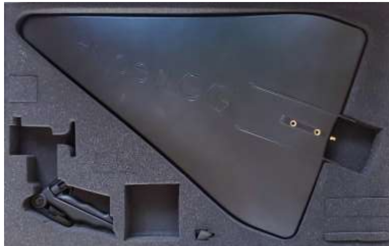
Figura 7-3. Antena receptora HyperLOG 30180.
