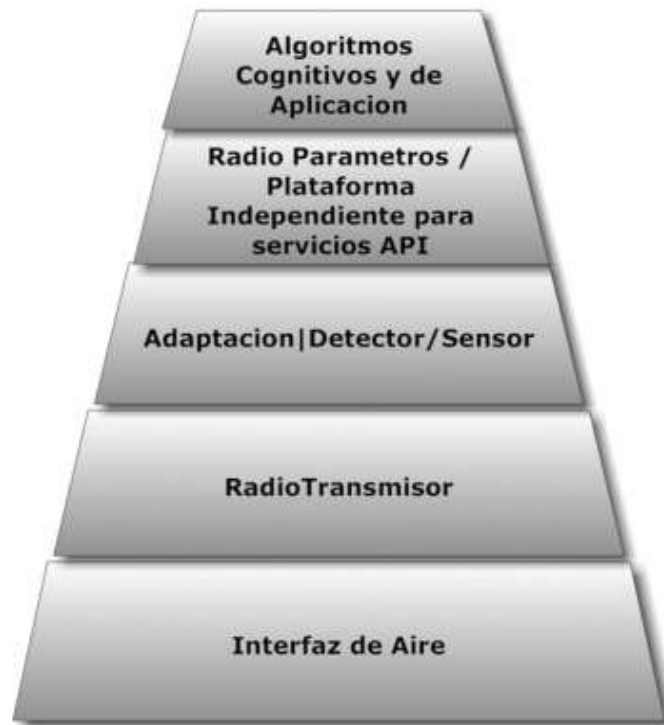
Figura 5-2. Modelo general de un sistema de radio cognitiva.
